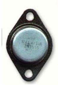
Gambar.1 Transistor kepingan logam di daerah power
